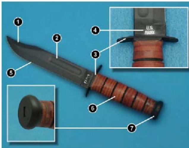
Устройство ножа. 1-скос, 2-дол, 3-гарда, 4-фальшлезвие, 5-основная режущая кромка, 6-рукоять, 7-навершие или головка
